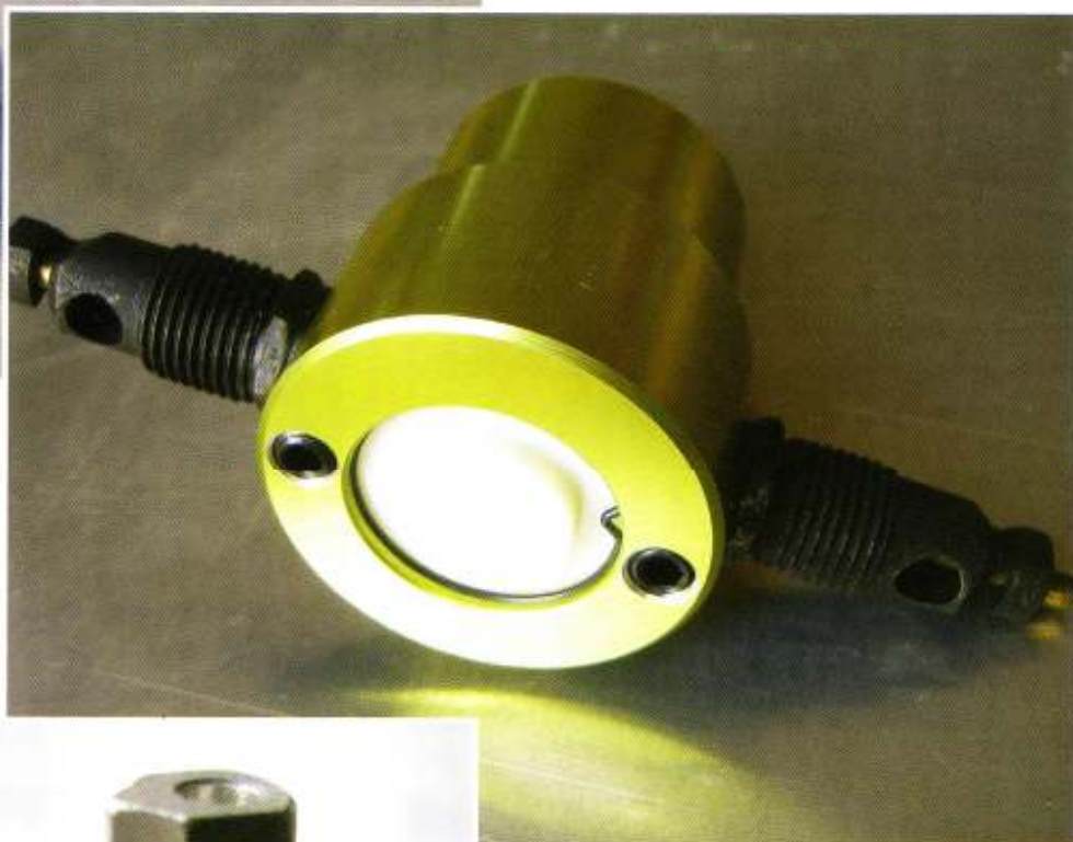
Nur wenige Verschraubungen sind zu lösen, um das Werkzeug zu zerlegen
